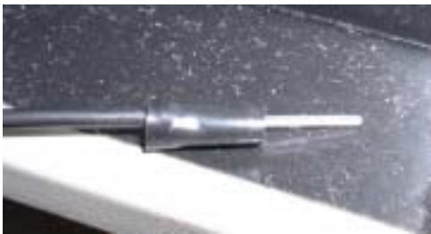
図 5: fiber 先端。図 6 中心の穴へ差し込む。図 6: 検出器前面より。光電面に fiber 挿入用の穴 (図の中心) のあいたプラスチックを取り付けた様子。
