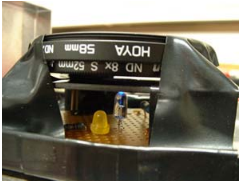
図 4: LED からの光は光学フィルターを通過させることで、single photon へと変換した。この手順により single photon counting が可能となる。この装置をケースで覆い、LED 上面から fiber を用いて光電子増倍管の光電面まで光を輸送した。
