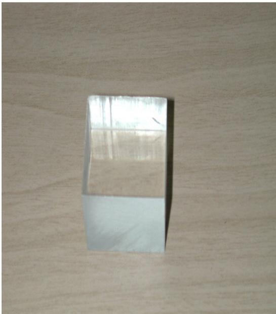
写真 2.2.5 : プラスチックシンチレータ
