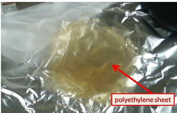
Fig. 3.3: TEMPO 混入後の polyethylene シート ( $3 \times 10^{19}$  spin/cc ESR 面積比較)
