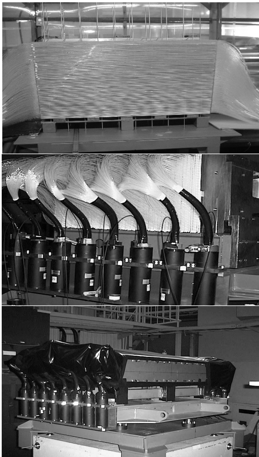
図 3.3: 1m-Module 製作中の写真。上が積層段階の様子で、真ん中が PMT へ fiber を接着している様子。下が最後に fiber を完全に遮光して完成したときの様子である。
