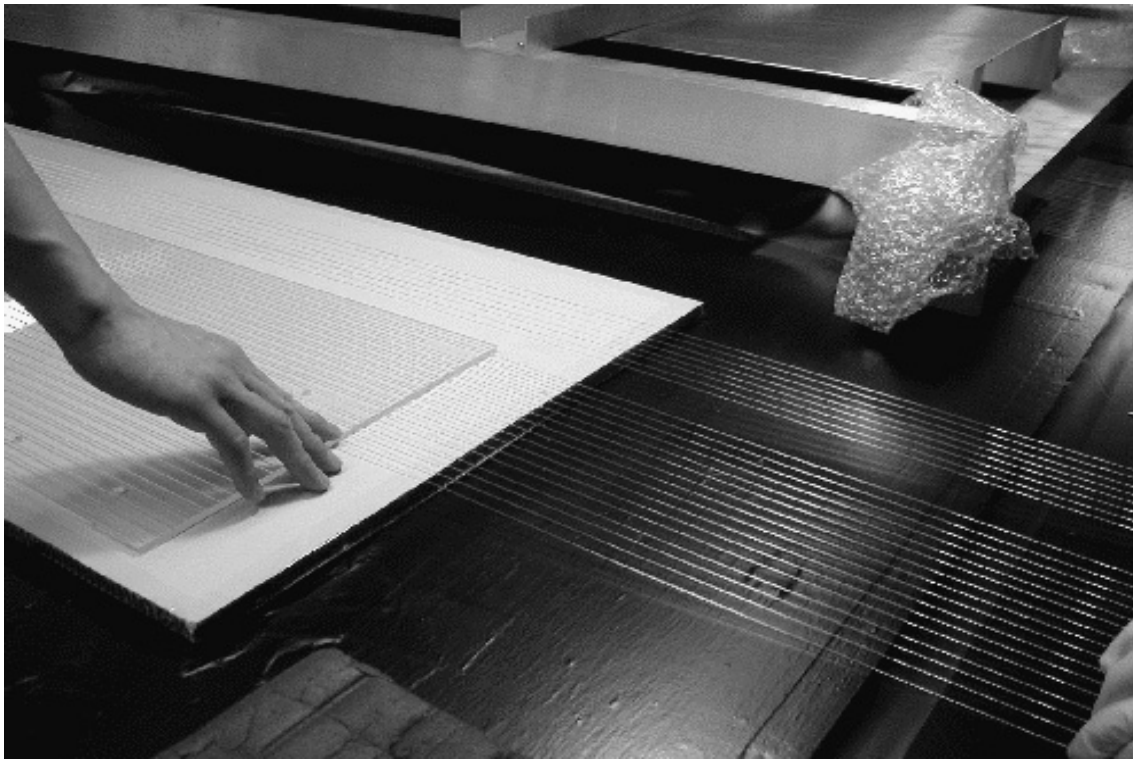
図 5.18: fiber 張りの様子。上が scintillator の溝に接着材を塗っている様子で、下がそこに fiber を埋め込んでいる様子。このように 1 本 1 本手作業で行なわれている。
