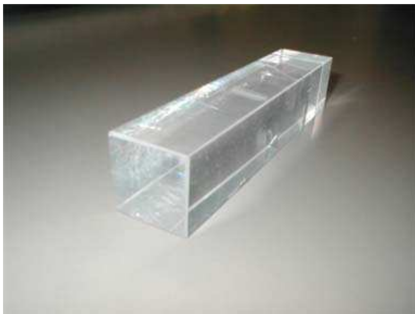
図 3.3: 実際の PbF_2 結晶。No.5 として使用した結晶である。少しクラックが入っている。
