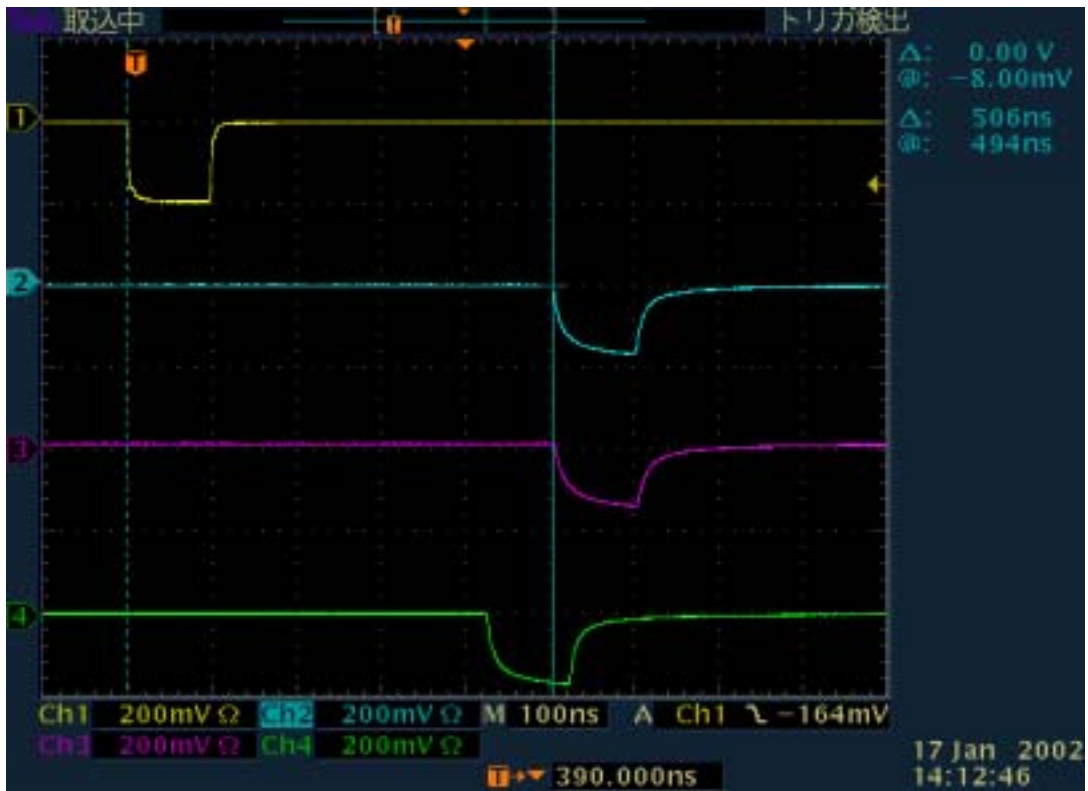
Fig.1 パルスハイト 200mV、width 100ns の場合
