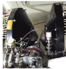
600アンプの電流によって励振を作る超伝導電磁石と電子検出器(EDM)を合わせた様子。
